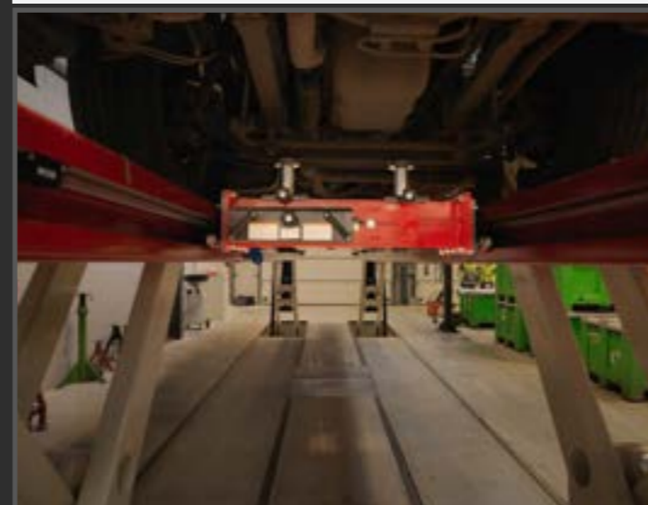
Automatische gegalvaniseerde opvul-volgvloeren voor de rijbanen en de brugkrik (brugkrik centraal gesitueerd)
