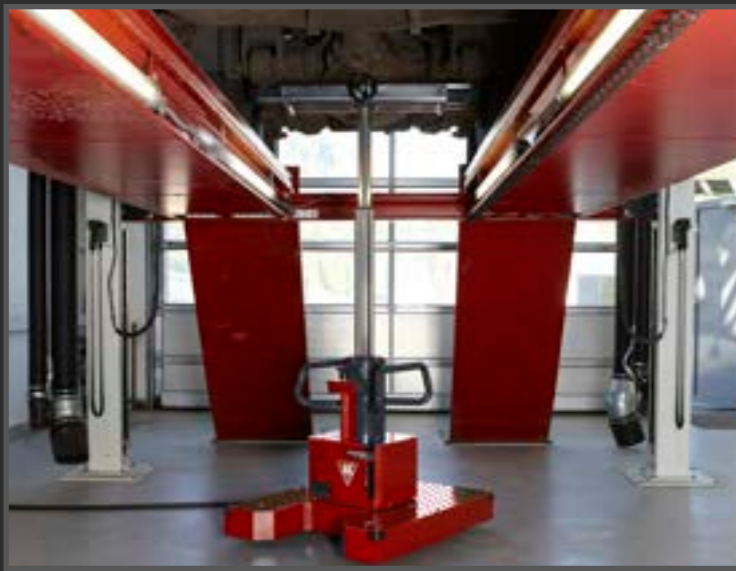
GGD150F min / max hoogte 920~2205 mm
