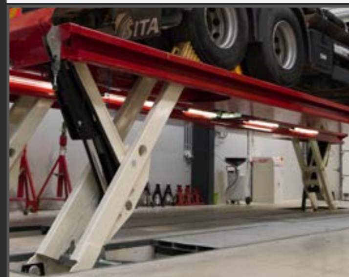
Automatische gegalvaniseerde opvul-volgvloeren voor de rijbanen en de brugkrik (brugkrik centraal gesitueerd)
