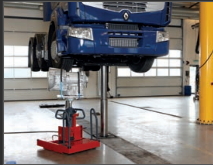
GGD150U min / max hoogte 920~2205 mm hefsysteem lateraal verschuifbaar
