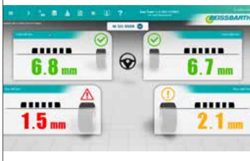
Easy Tread Analyse van de banden tijdens het overrijden van de meetunit OEM profieldieptemeter
