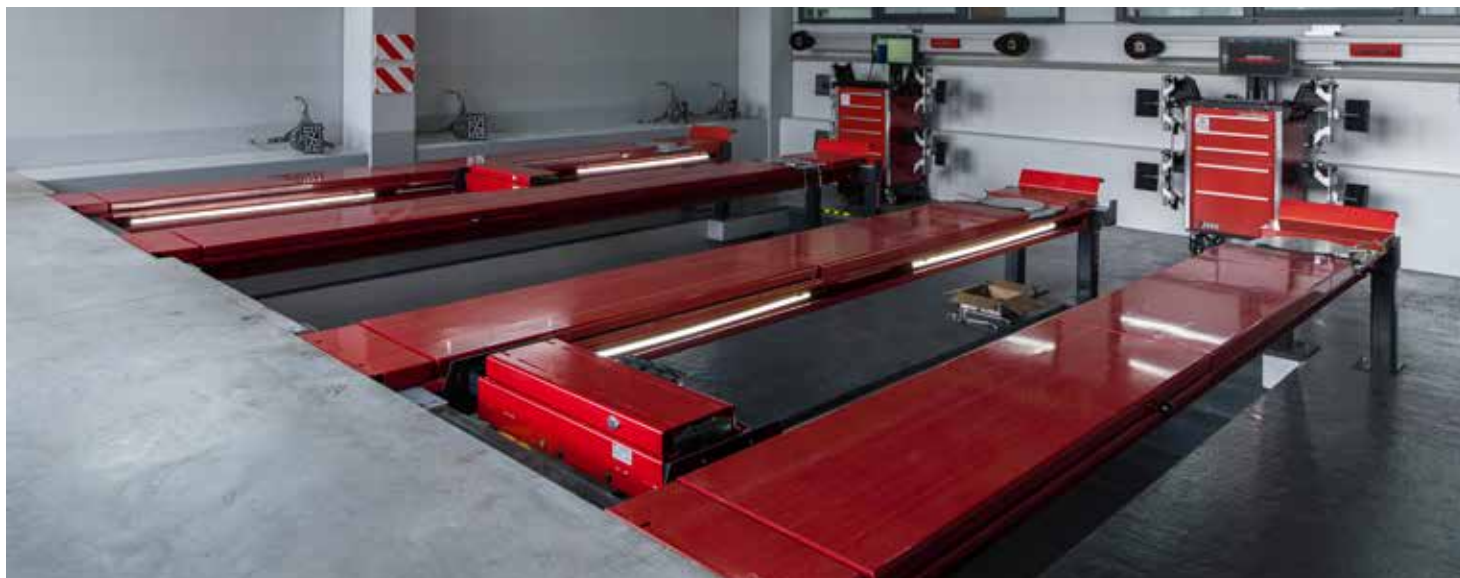
John Bean 3D wieluitlijners · in combinatie met een werkput Middellange rijbanen voor personenvoertuigen · lange rijbanen t/m lange bestelwagens
