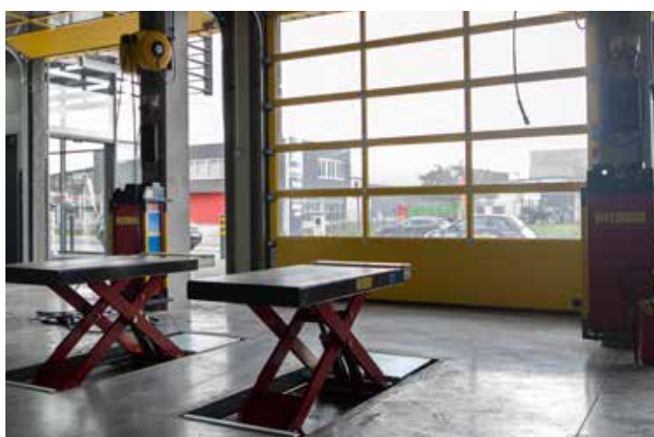
Corgi Erco · 4 bandenhefbruggen · 3 t · elektrohydraulisch
