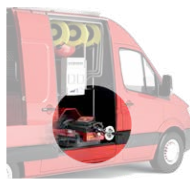
EM 9050 Slide • motor 230 V Schuift uit het voertuig
