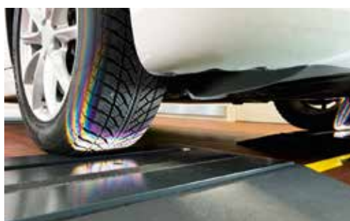
Easy Tread Analyse van de banden tijdens het overrijden van de meetunit OEM profieldieptemeter
