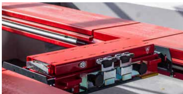
▲ AC pneumatische brugkrik rijbanen met LED verlichting
