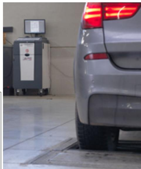
OEM freinomètres et testeurs de suspension
