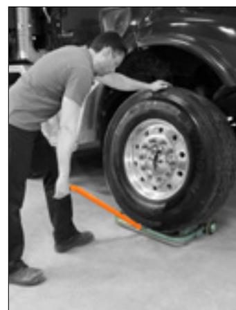
Chariot porte-roues - pour pneus jusqu'à 125 kg et Ø 1219 mm
