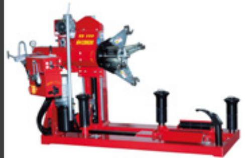
Equipé de 2 talons-poussoirs avec fonction de (dé)montage (3 ph ou mono)
