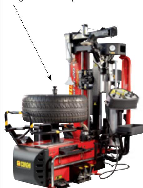
Détalonneur à double disque pour le détalonnage du pneu en toute sécurité
