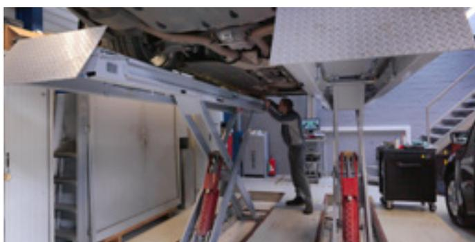
Ponts élévateurs à simple ciseaux
