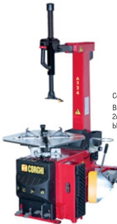
Colonne pneumatique basculante
