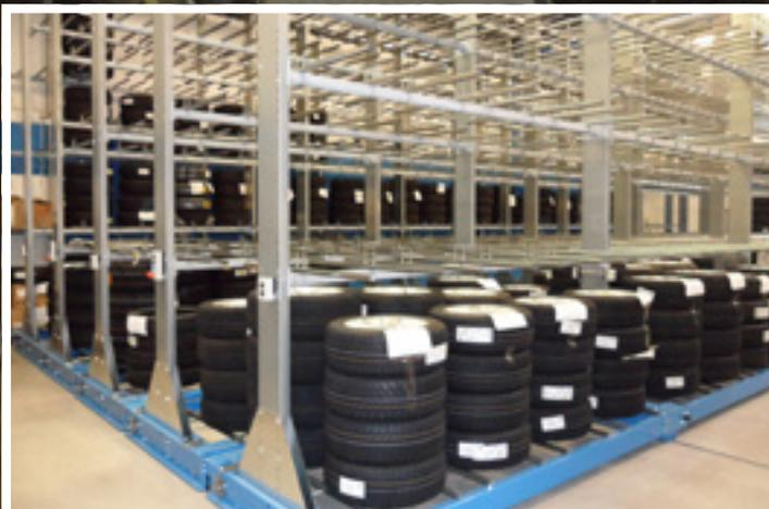
Gain de place jusqu'à 90% grâce à des rayonnages déplaçables sur rails
