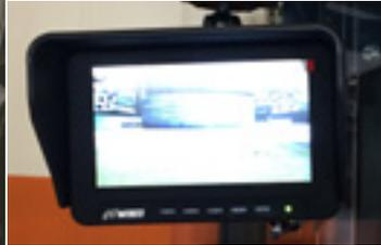
Caméra pour le positionnement des piles de pneus en hauteur (option)
