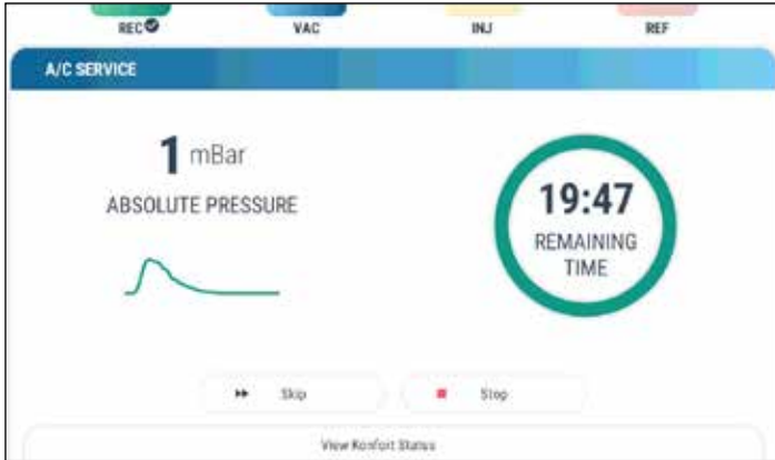
«Vacuum» fase: er wordt een vacuüm opgewekt in het aircosysteem van het voertuig om te controleren op eventuele lekken
