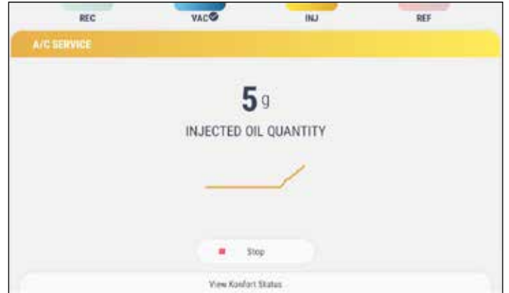
«Olie-injectie» fase: het systeem injecteert de juiste hoeveelheid olie in het voertuigsysteem om te smeren.
