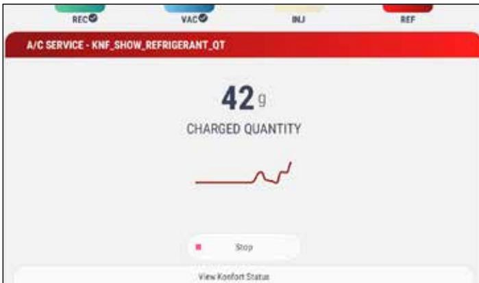
Phase "recharge de réfrigérant" : la station charge la juste quantité de gaz dans le système du véhicule.
