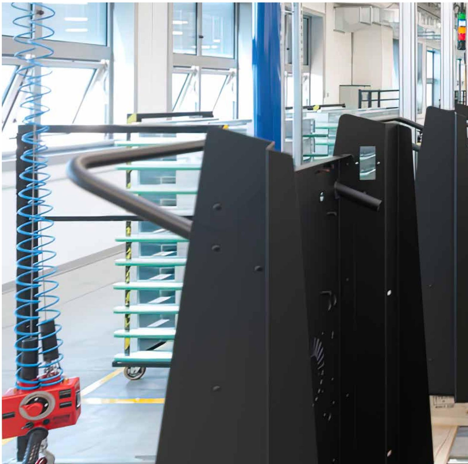
Après l'assemblage, la station entre dans la phase d'essai où s'effectuent les contrôles électriques ainsi que la calibration des capteurs de balance et de pression. Le test vérifie que tous les composants et dispositifs répondent de façon adéquate aux différents essais et fonctionnent en conformité avec les spécifications.
