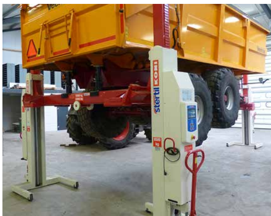
Dwarsbalk voor voertuigen met lage bodemvrijheid voor wielvrij onderhoud.
