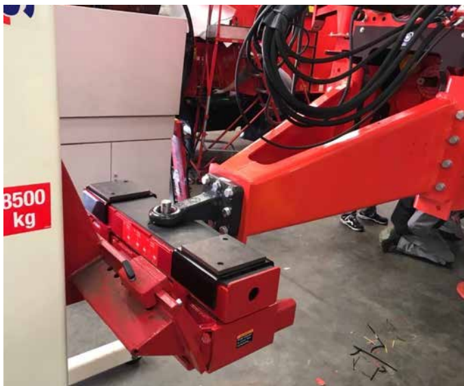
Adaptateurs polyvalents pour levage de véhicule avant et arrière roues pendantes avec deux ou trois colonnes de levages à 2 ou 3 colonnes.
