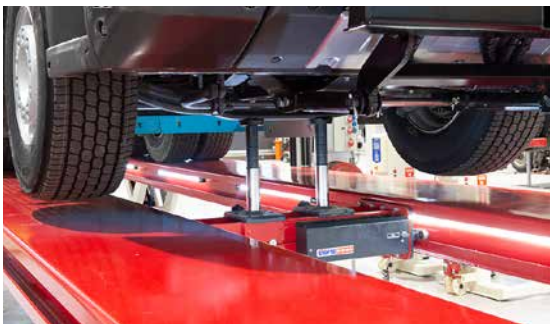
Doubles traverses de levage adaptées à tous les chemins de roulement.
