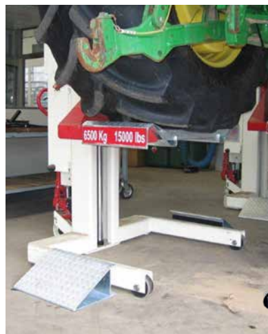
Réducteur de fourches de levage pour les véhicules avec roues encastrées.
