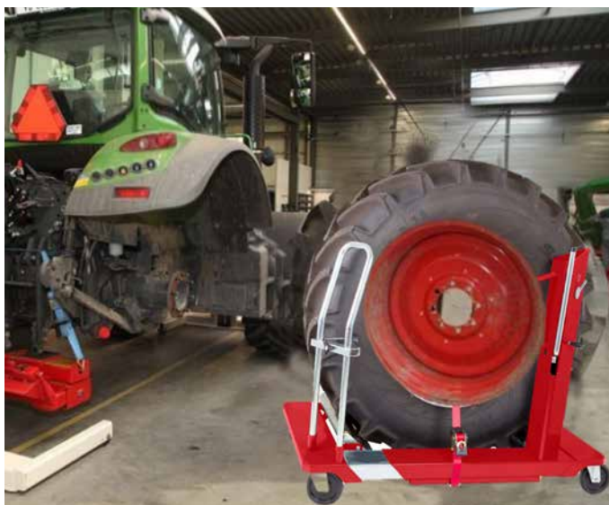
Chariot pour roues pour un retrait pratique et ergonomique des roues larges.
