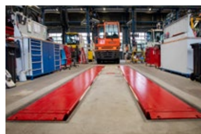
Version encastrée avec système de protection anti-descente
