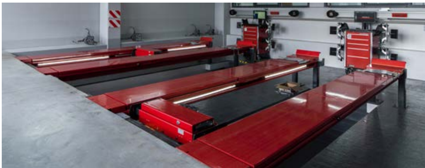
John Bean 3D → zone de géométrie en combinaison avec une fosse de travail Version avec chemins de roulement de longueur moyenne → pour voitures Version avec chemins de roulement longs → pour camionnettes
