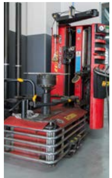
Corgi Master 26 ► démonte-pneus du type sans levier pour traiter tout type de pneus/ jantes
