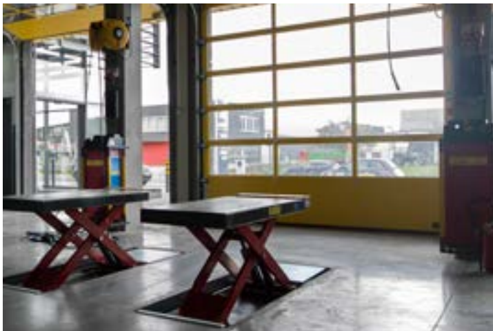
Corgi Erco • 4 ponts service pneus • 3 T • électrohydrauliques
