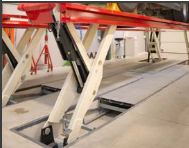
Automatische gegalvaniseerde opvul-volgvloeren voor brugkrik en rijbanen. De brugkrik bevindt zich in centraal gesitueerde opbergpositie
