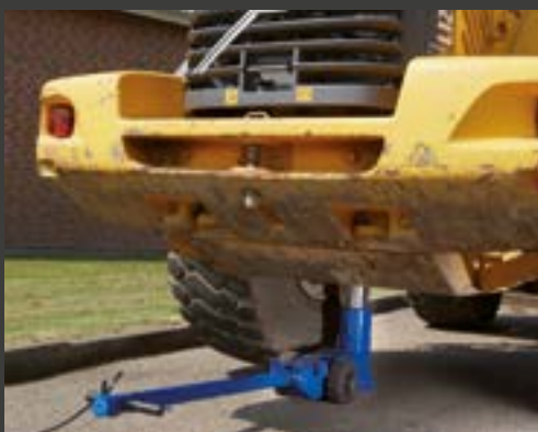
65-1 / 65-1H (foto) versies met 2340 mm lange telescopische arm - vergroot de reikwijdte onder het voertuig (optie)
