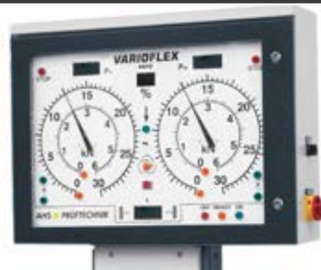
Grote, duidelijke wijzerschalen (foto 306 Easy) Binnenschale tot 6 kN - buiten tot 30 kN
