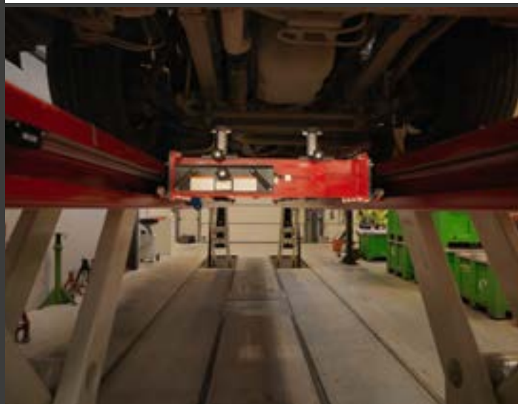
Automatische gegalvaniseerde opvul-volgvloeren voor brugkrik en rijbanen. De brugkrik bevindt zich in centraal gesitueerde opbergpositie
