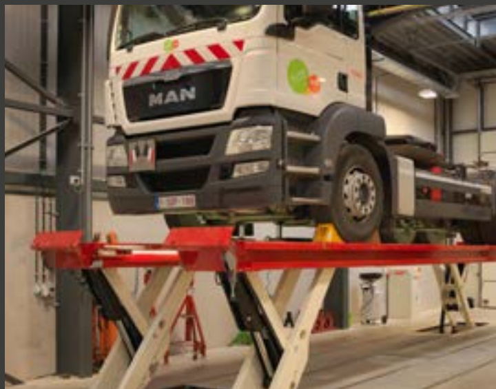
35 ton sterk Lengte rijbanen 10 m
