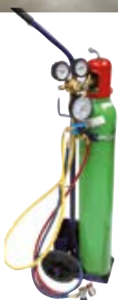
Dichtheidstest via stikstofdruk
