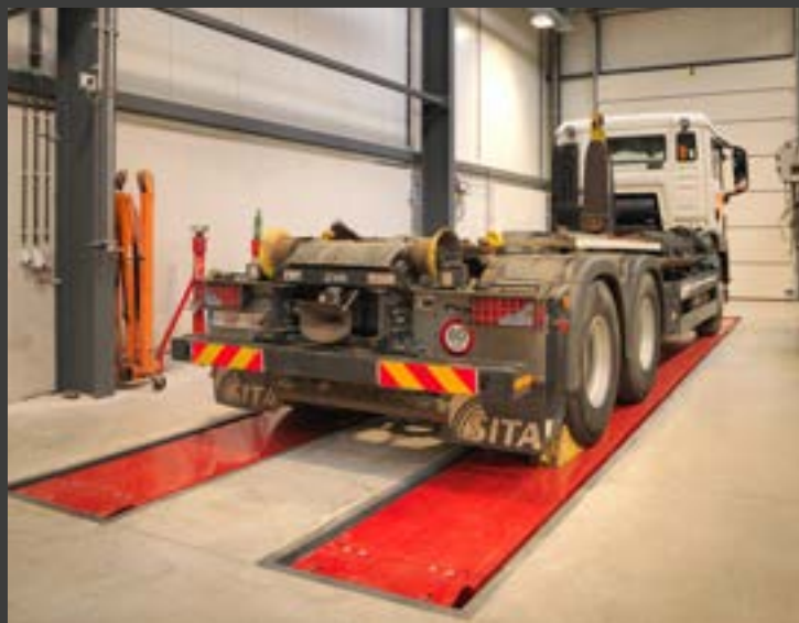
Vlakke vloer • Rijbanen, scharnierende voertuigweershouders, alsook de brugkrik zijn in ruststand in de vloer verzonken
