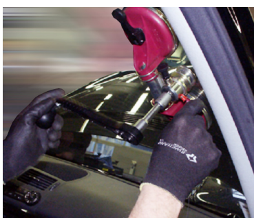
Système de démontage vitres voitures et camions
