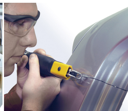
Système de démontage vitres voitures et camions
